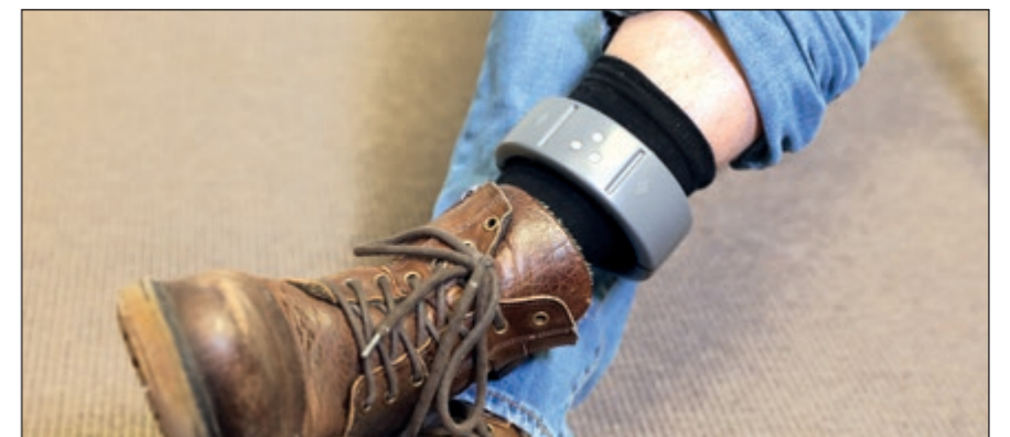
Slik ser den omvendte voldsalarmen ut. Fotlenken må lades i to timer daglig, og den som pålegges å gå med den, kan ikke oppholde seg mer enn i tyve minutter uten mobildekning før alarmen går. Når alarmen går, vil politiet ha 20 til 25 minutter på å ta seg frem til den truede, for å beskytte ham eller henne. FOTO: MORTEN UGLUM / AFTENPOSTEN / NTB SCANPIX
